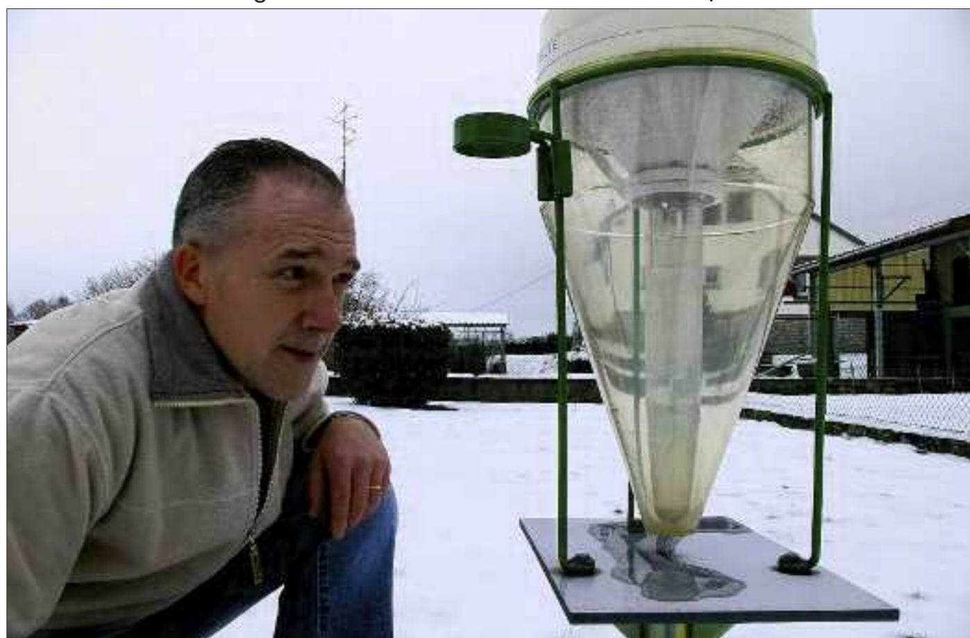
Jean-Luc Feltmann devant le pluviomètre qu'il a planté dans son jardin. Un lieu idéal car plat, sans obstacles et parfaitement exposé au soleil. Photo Laura Bourst
